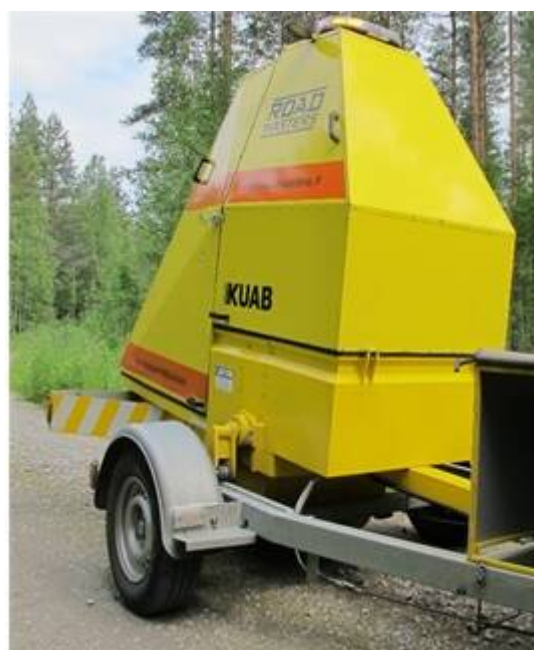
Auton perässä vedettävä KUAB-pudotuspainolaite. Kuva: Ilppo Greis.
