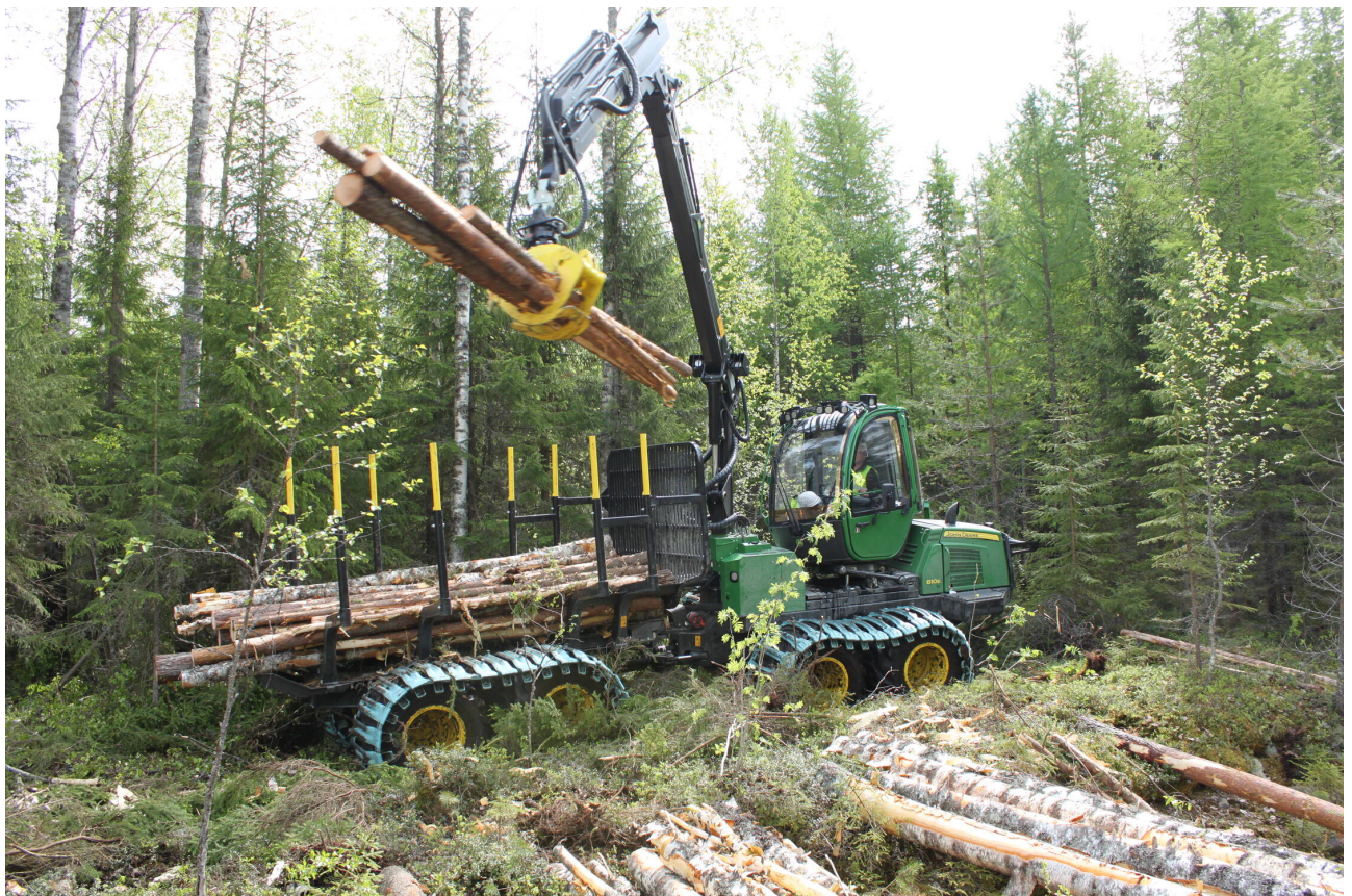
John Deere 810E varustettuna pehmeän maan telavarustuksella, kuten leveillä Eco-Track tai Eco-Magnumteloilla, soveltuu hyvin yleiskoneeksi suomensien puunajoon. Kuva: © Kalle Vanhatalo.
