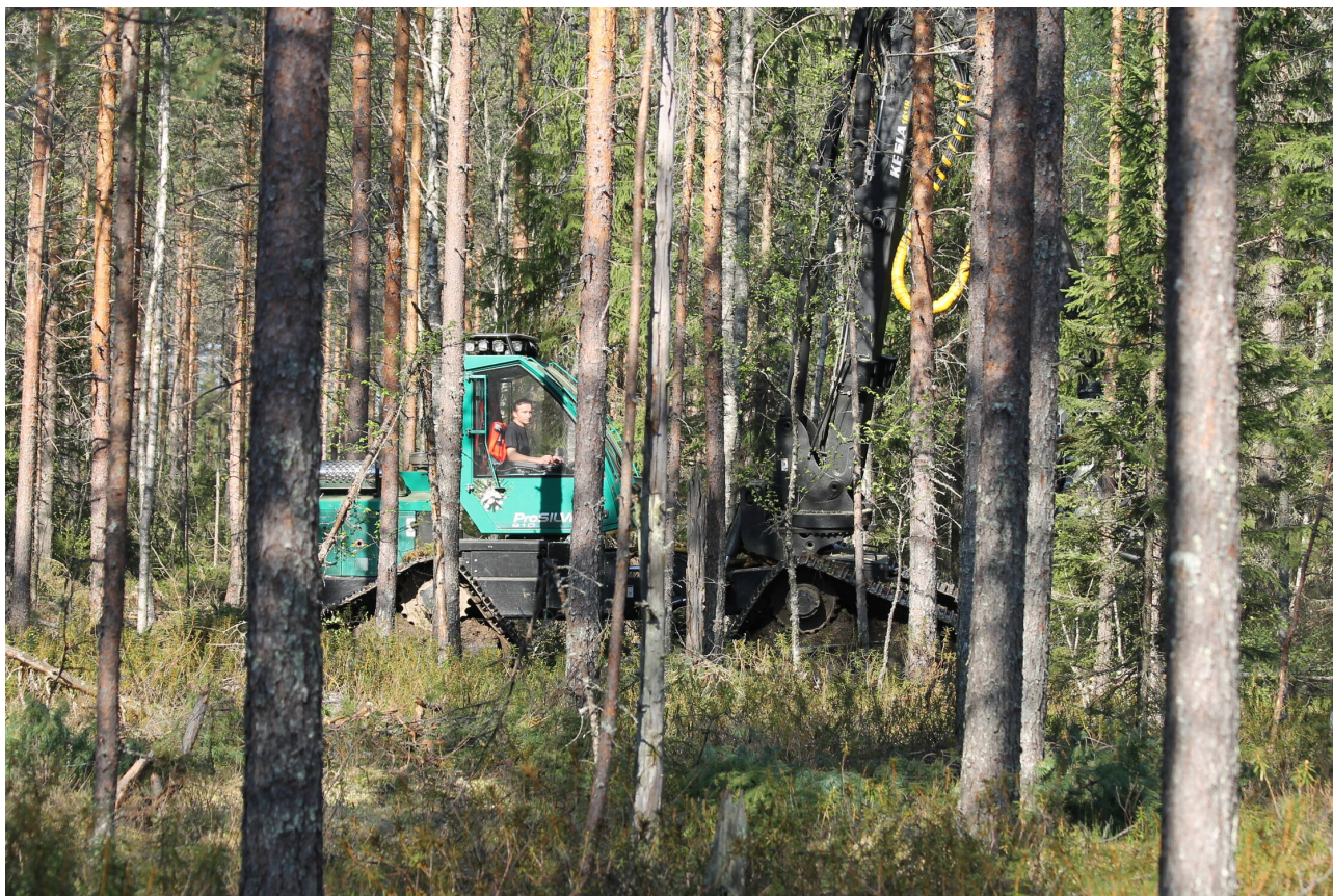
Kiinteätelainen ProSilva-hakkuukone. Kuva: © Esa Pienkellomäki.
