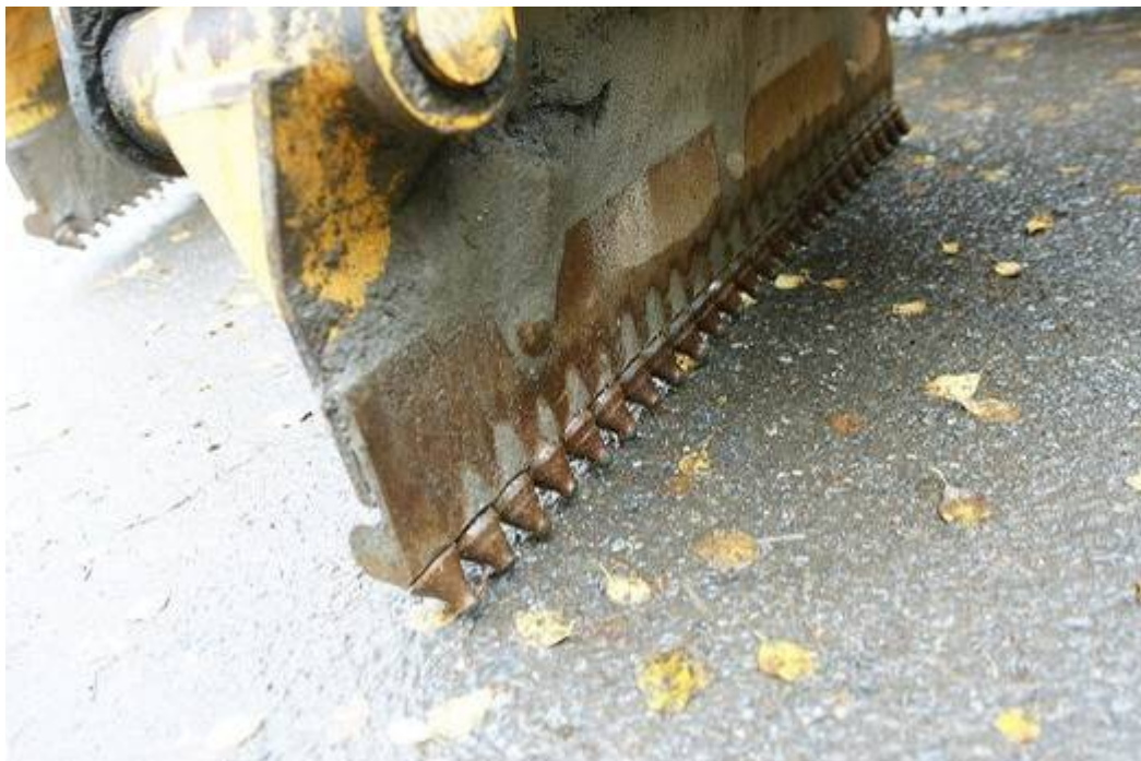
Tappiterä soveltuu parhaiten kulutuskerroksen leikkaukseen. Kuva: Martti Perälä.
