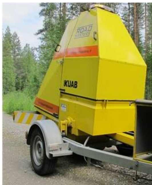
Fallviktsapparat av märket KUAB monterad på en släpvagn. Bild: Ilppo Greis.
