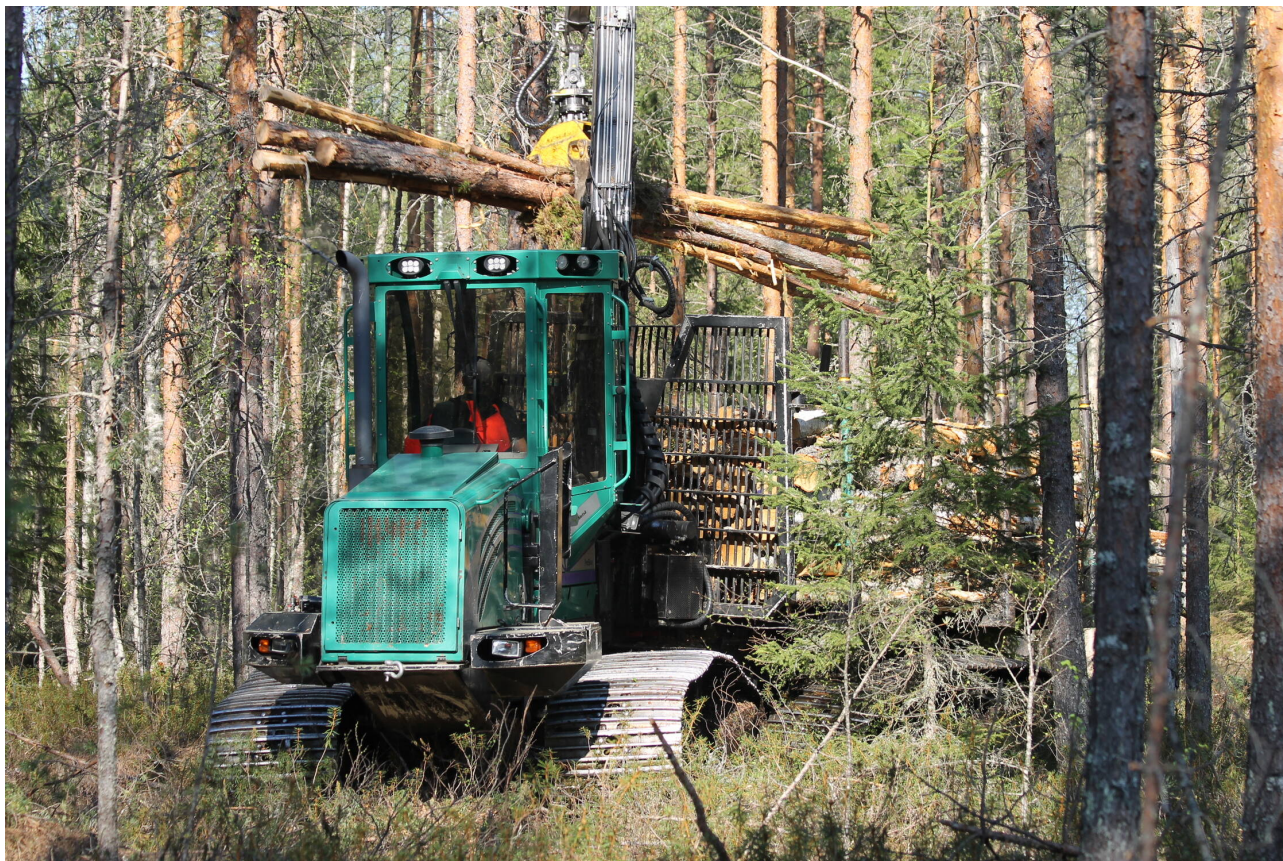
Den banddrivna ProSilvaskotaren är planerad särskilt för virkesdrivning på torvmark. Bild: © Esa Pienkellomäki.
