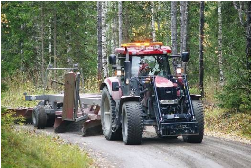
Sladdning av skogsbilväg med tung utrustning, sidovingen i uppfällt läge. Bild: Navico Oy.
